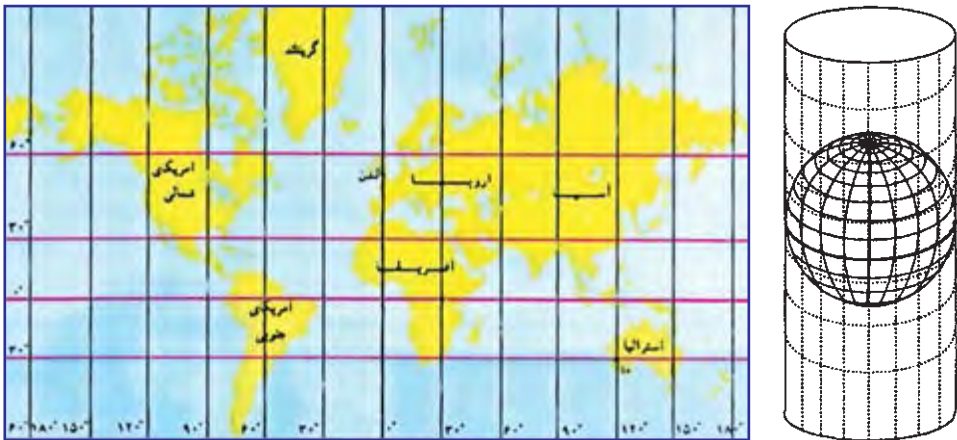
شکل ۷- سیستم تصویر استوانه‌ای
