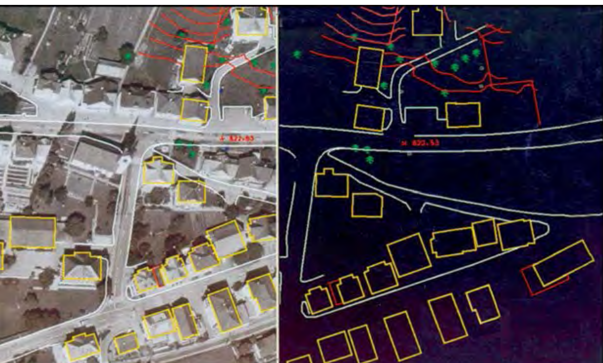
شکل ۸ - تهیه نقشه از روی عکس هوایی
